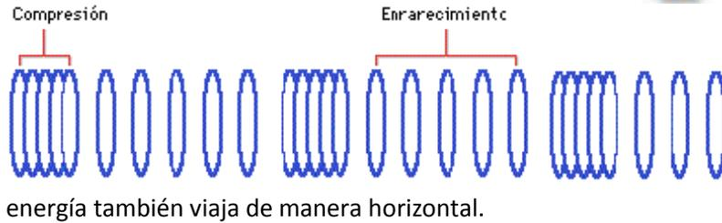
**Ondas longitudinales:** Son aquellas en donde las partículas del medio vibran en la misma dirección de la onda, por ejemplo el sonido y las ondas sísmicas primarias. En el dibujo las partículas se comprimen y descomprimen horizontalmente, mientras que la energía también viaja de manera horizontal.
