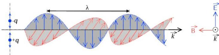
Otra característica general de las ondas electromagnéticas es la velocidad de propagación, que en el vacío alcanza un valor de 300.000 km/s, velocidad con la cual seríamos capaces de dar una vuelta a la Tierra en 20 milisegundos. Ejemplo de éstas son la luz y las ondas de radio.
